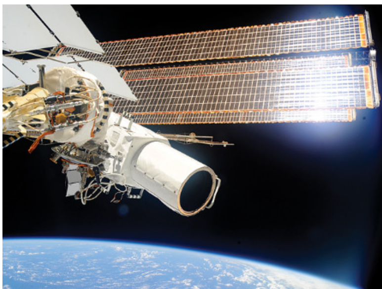
RYSUNEK 2. Satelita SkyBox dla Google Earth na orbicie. Ogniwa fotowoltaiczne są rozłożone i zasilają urządzenia satelity. [autor: UrtheCast, [7]]
