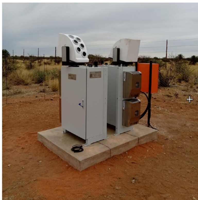
RYSUNEK 4. Dwie stacje systemu OpticalFence w jednej lokalizacji, środkowy element sieci przeznaczony do obserwacji satelitów na niskich orbitach.
