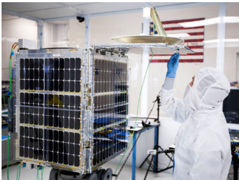
RYSUNEK 1. Satelity wyprodukowane przez Skybox dla Google Earth, w laboratorium na Ziemi przed wysłaniem na orbitę. Widoczne ogniwa fotowoltaiczne złożone do transportu. (fot. M. McDonald [6])
