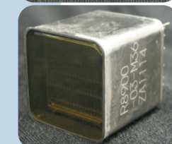
▲ Fotonowielacze Aktywna powierzchnia PMT stanowi 85% (z kwadratu o boku 26.2 mm) i dzieli się na 6x6 = 36 pikseli.
